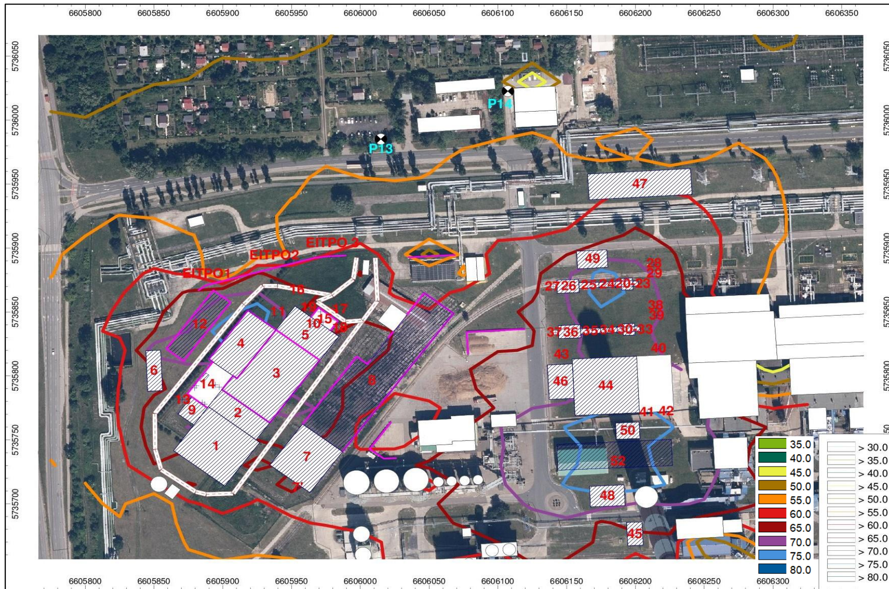
Rysunek 12 Mapa hałasu - eksploatacja oddziaływanie skumulowane ITPO i CCGT - pora dnia [dBA]
